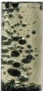
図4 温度60℃の水に空気を吹き込んだ様子
